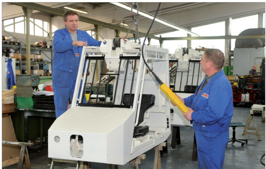
Speziell ausgebildete Fachkräfte montieren am Standort Hamm eine Einschienenhängebahn
